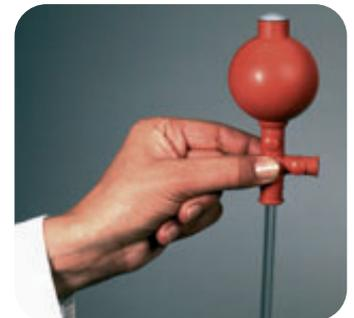
Soufflez sur la pipette (pas d'actionnement de la valve nécessaire).
