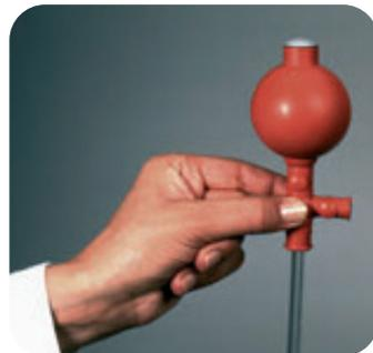
Aspiration par pression sur le point de fonctionnement. ↑
