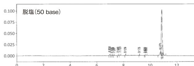
任意の配列を合成し、キャピラリー電気泳動による純度比較を実施。逆相カラム精製を行う事で合成不良に起因する低分子側の夾雑ピークを効果的に除去する事が可能。
