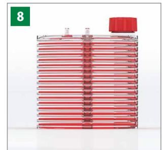
CELLdiscを立ち上げでから、インキュベーター内に培養面が水平になるように静置してください。
