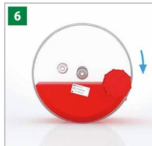
液体を平衡するためCELLdiscをCELLstageから降してください。水平に置き、培地と全ての層が充填ポートを介して貫通するように回転してください。
