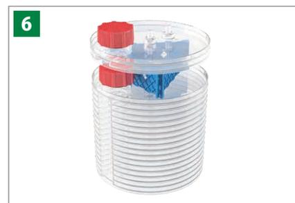
他のCELLdiscをスタッカーの上に積重ねます。下のCELLdiscの通気はセグメントにある穴によって保たれます。さらに、上に積載したCELLdiscの平面性はセグメント上の“elevation”により保たれます。
