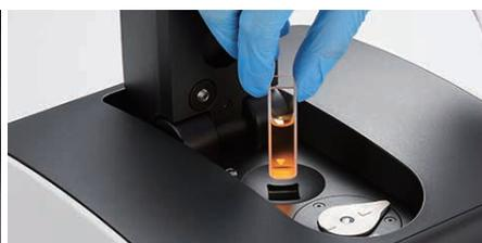
LEDアシストライトにより溶液の滴下をサポート
